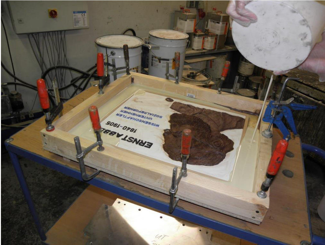
Abbildung 4: Urr relief bei der Herstellung der Negativform
